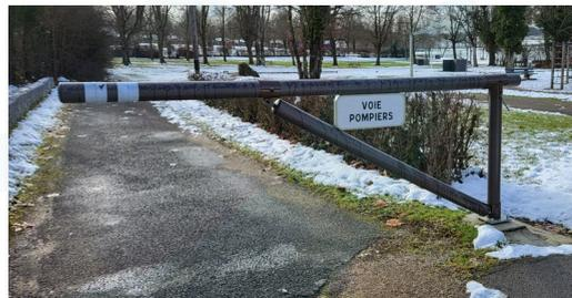
Barrière pivotante verrouillable ouverte ou fermée
